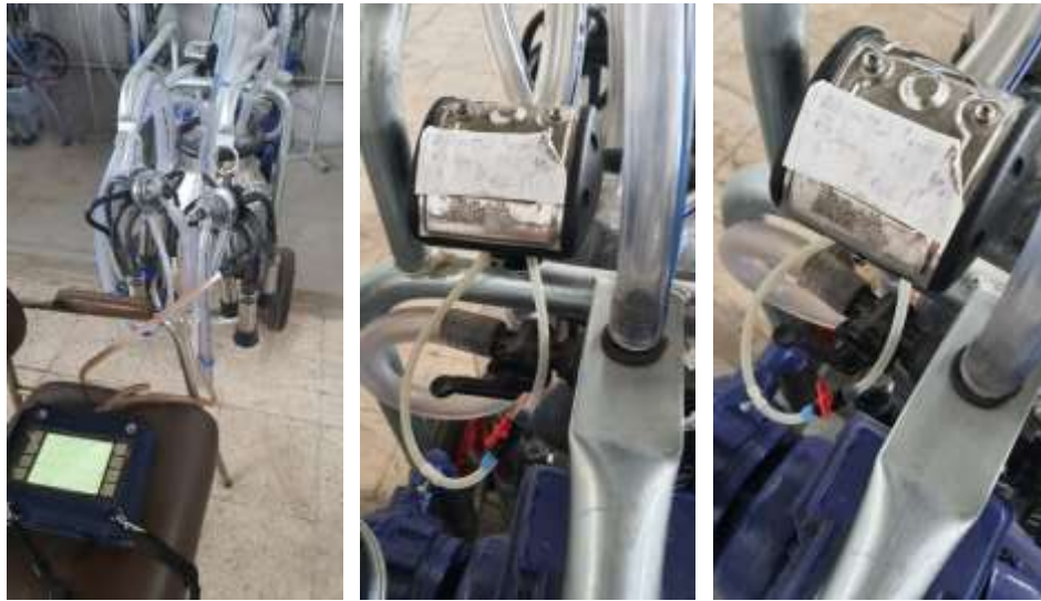
Şekil 5. Vakum-nabız ölçüm cihazı ile tasarım pulsatoründe yapılan vakum-nabız ölçüm görüntüleri
